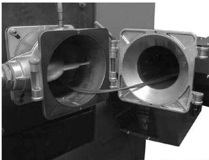
Вставьте корпус горелки в шарнир газовой обоймы и закрепите его при помощи крепёжного стержня. Горелка находится при этом в сервисном положении
